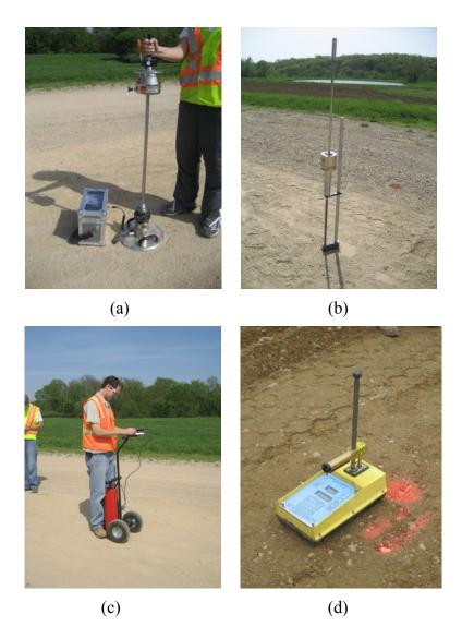
Figure 8. (a) 300-mm Zorn LWD, (b) DCP, (c), 20-kg Clegg hammer, (d) Nuclear moisturedensity gauge
