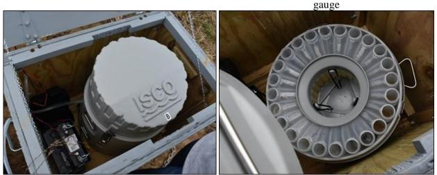
(c) 12V marine battery (d) Sample bottle array Figure 6.7. Automated sampler apparatus on Tama US 30
